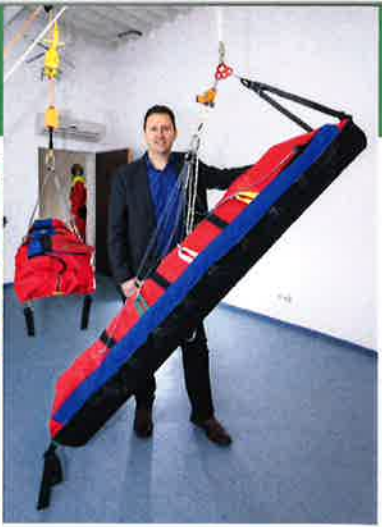
Das neue Rettungssystem für Bergungen aus Tunneln, Schächten oder Höhlen
