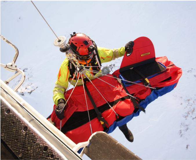
**Hocheffektives, aerodynamisches System zur Verhinderung bzw. zum Stoppen von Rotationsbewegungen des Bergesacks.**
