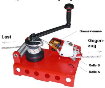
Bremsklemme wird durch den Zughebel geöffnet, das Abseilen kann beginnen.
