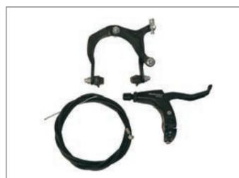
U-Brake mit austauschbaren Bremsbelägen, Kabelführung und Bremshebel. Dieser kann links oder rechts am Griff montiert werden. Bei Demontage des Rades kann das Kabel am Bremshebel ausgehängt werden.
