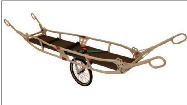
Rahmen aus ovalförmigen Aluminiumrohren, Liegefläche aus Alu-Sandwichplatten, umlaufende Schutzreling, zusätzliche Schutzabdeckungen im Kopf- und Fußbereich.
